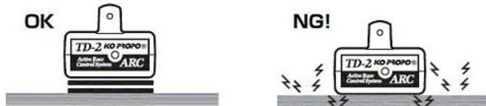
シャーシに直接取り付ける場合には、右の例のように、密着させて取り付けると、電波がシャーシの影響を受けてうまく下にあるアンテナに届きません。この場合は、厚手の両面テープを2~3枚重ねて取り付けるようにします。
