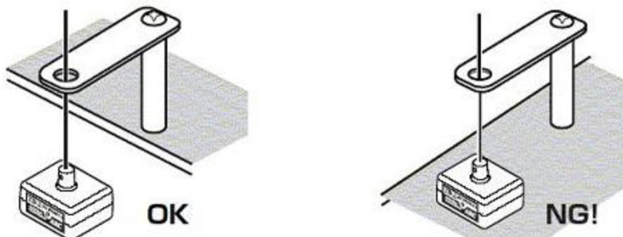
車体側に、ポンダーステーと呼ばれる、専用取り付け位置があれば、そこに取り付けます。ただし、上の図のようにシャーシの下から見える位置に取り付けてください。
