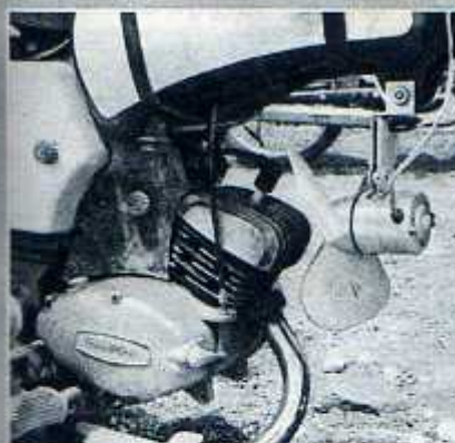
ファンを取つけたシルクベツで登坂時の冷却テスト 結果はいたって良好
