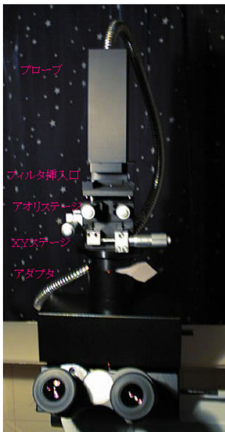
写真1 顕微鏡搭載型ヘテロダイン変位計の外観 (変位計、落射証明系、CCD部はこの写真には写っていません、試料ステージは自動ステージです。)
