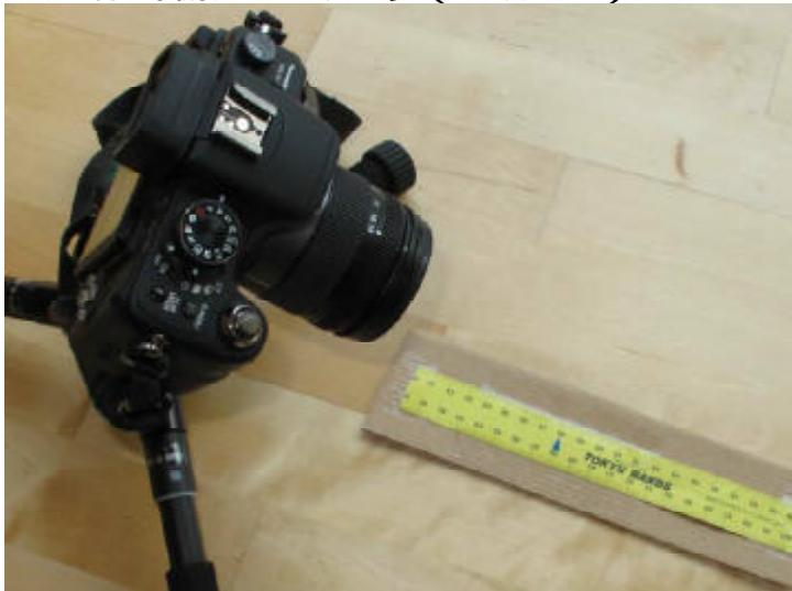
カメラを、定規に対して約45度位にセットし、定規の88の中心の紺色の矢印の先にピントを合わせてください。
