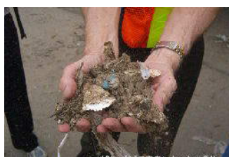
▲堆肥化で安定化させた廃棄物
