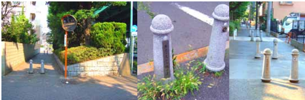
広い歩道の半分以上を緑地に使う例。これは甲州街道沿いで高速下という状況で防音や排気ガスへの配慮と思われる。歴史と文化の散歩道と名前のついた石の石柱があります。これは駐車場入口や道路入口の両脇に配置して歩行者や自転車への安全上の配慮でしょう。
