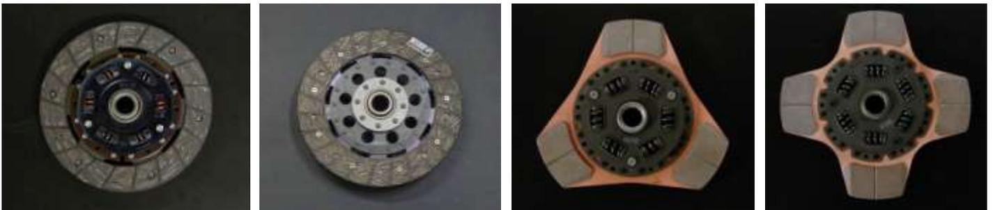
リジット・クラッチディスクは車種及びドライバーの好みに応じるために[ノンアスタタイプ][フルメタルタイプ(Mタイプ)]の2種類が用意されています。
