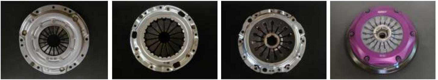
リジット・クラッチカバーは車種別に[コンベタイプ(C)][ターンオーバータイプ(T)][プルタイプ(P)][ツインプレートタイプ(WP)]の4種類のクラッチ方式を採用し、ハードなクラッチワークに耐えうる高圧着力で設計しました。エンジンパワーを最大限に伝達するため必需品です。
