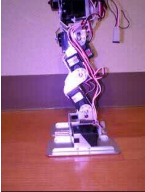
下腿をサーボモーター個分前方にオフセットさせます。これはオフセットアームというオプションパーツを使用します。以前のモーションデータも、ホームポジション設定後に再ダウンロードすれば流用可能です。
