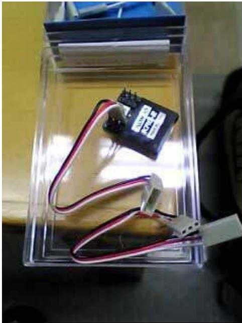
ジャイロ回路に延長ケーブルを挿した状態。下側が本来のケーブル。
