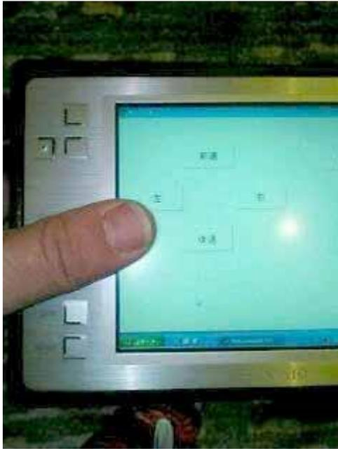
type Uはタッチパネルなので、800×600液晶にあわせてRCBCommanderの画面サイズとボタンサイズを調整することで、まさに「KHR-1専用のティーチングペンダント」をつくることができます。
