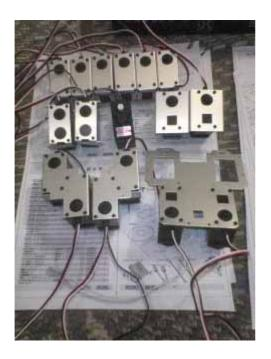
アルミフレームにサーボモータを取り付け。
