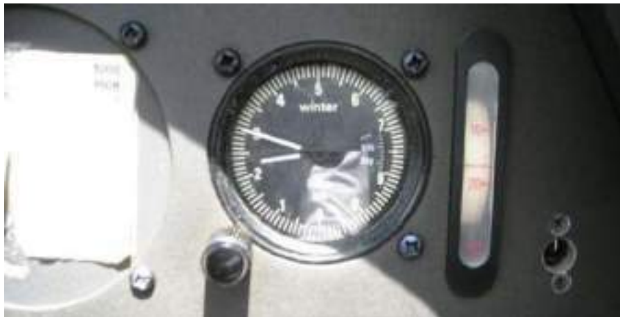
高度2,300m。短い針が千の位、長い針が百の位以下を示す。
