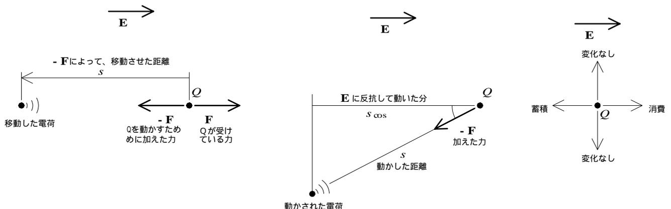
図1-13 電荷の移動によるエネルギーの増減
