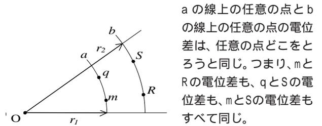
図 1-18 ひとつの電荷により作られる電位
