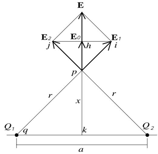
図1-8 2個の等しい電荷からなる電界の計算
