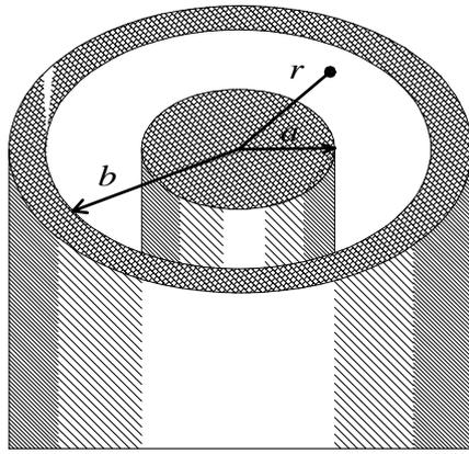
図 1-31 同軸コンデンサ
