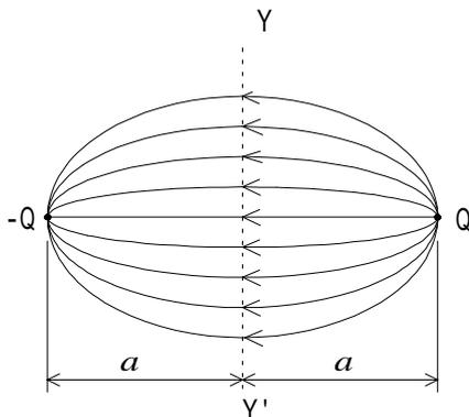
図 1-40 影像法により電界を求める
