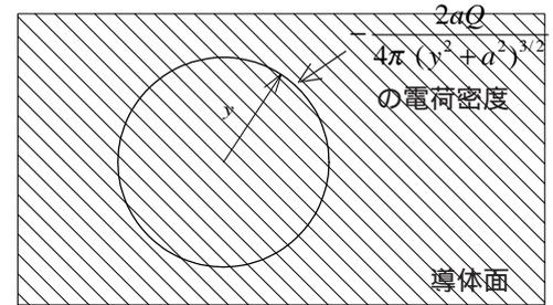
図 1-41 平面導体に誘起する電荷
